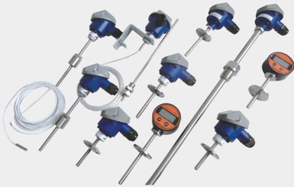
铠装热电阻可用于测量-70-600℃范围内温度，可直接用铜导线和二次仪表相连接使用，由于它具有良好的电阻输出特性，可对各种测温要求条件进行温度测量，提供精确的温度变化输出信号，符合JB/T8622-1997标准。
